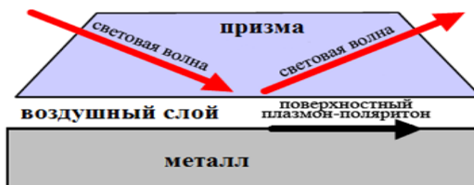
Рисунок 1 – Распространение плазмон-поляритонной волны в волноводной структуре (конфигурация Отто, 1968 г. [2])
