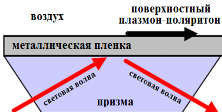
Рисунок 2 – Распространение плазмон-поляритонной волны в волноводной структуре (конфигурация Кречманна, 1971 г. [2])
