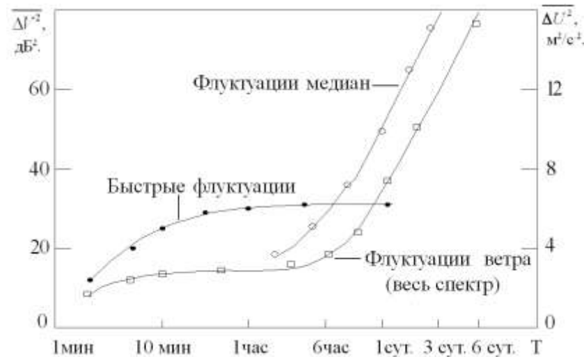
Рисунок 6.10 – Зависимость интенсивности флуктуаций множителя ослабления и скорости ветра от времени осреднения
