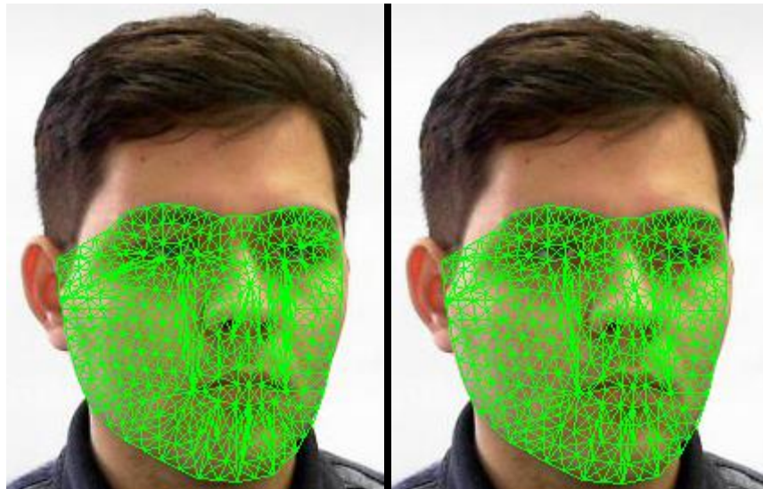
Рис. 23. Сетка из тысячи треугольников: а) полученная с критерием разбиения по максимальной площади; б) полученная с критерием разбиения по максимальной длине стороны
