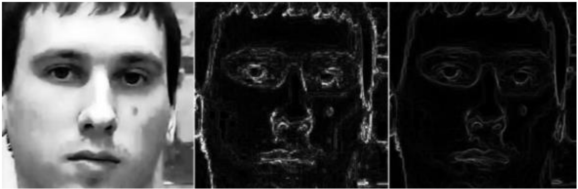
Рис. 6. а) исходное изображение; б) выделение контуров оператором Лапласа; в) выделение контуров оператором Робертса
