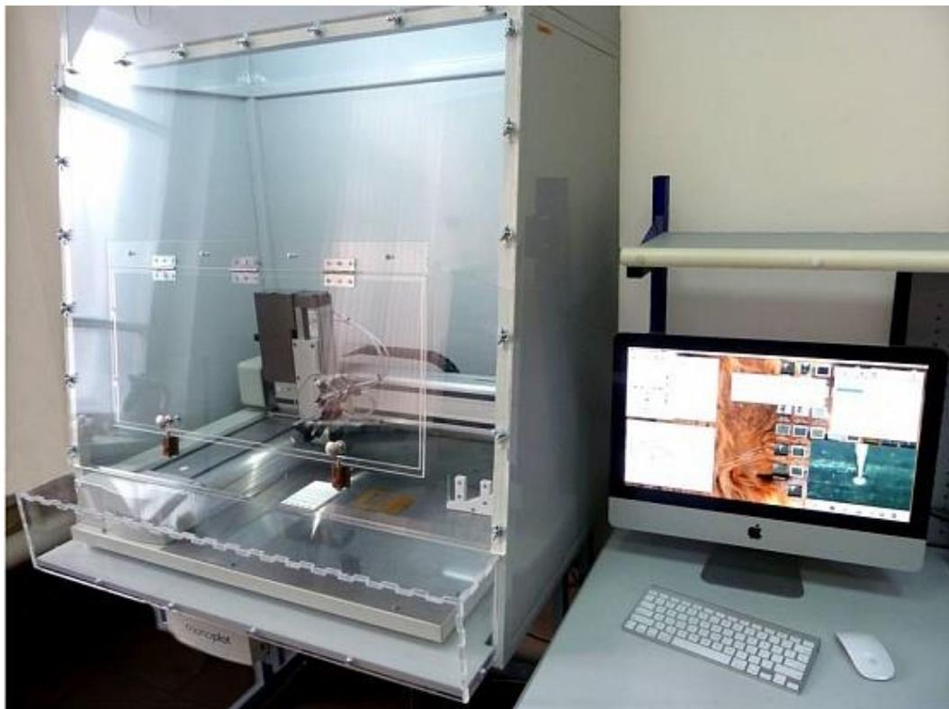
Рис. 1. Платформа УНУ, в которой реализуется ультразвуковое дозирование чернил при печати на подложку
