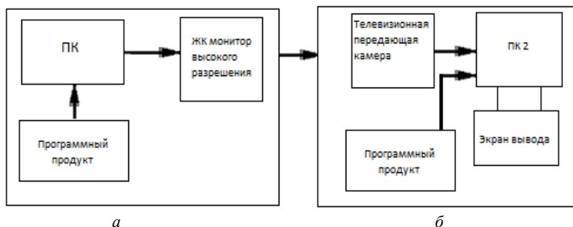
Рис. 2. Структурная схема устройства для оценки коэффициента геометрических искажений с повышенной точностью.
