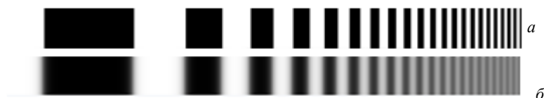
Рис. 1. Оригинальное изображение – а ; изображение, искаженное объективом, – б
