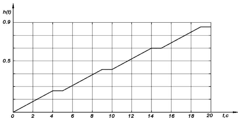
Рис. 4. Осциллограмма переходной характеристики контура компенсации момента закручивания пружины
