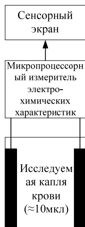
Рис. 1. Структурная схема разрабатываемого устройства
