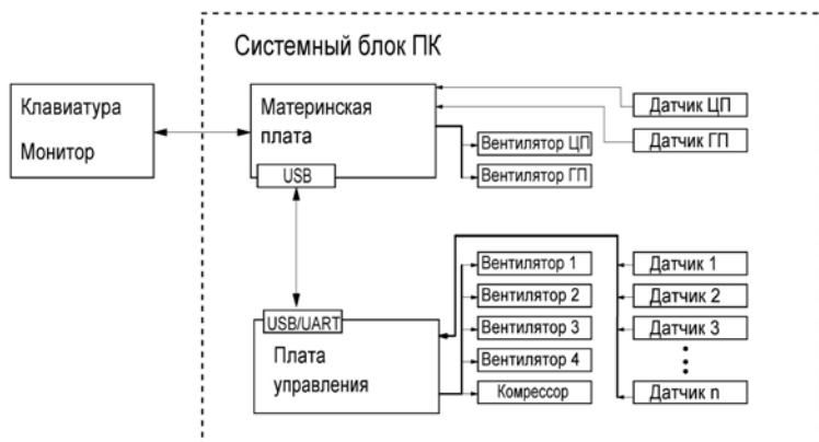
Рис. 1. Блок-схема системы управления в «Ice-box»
