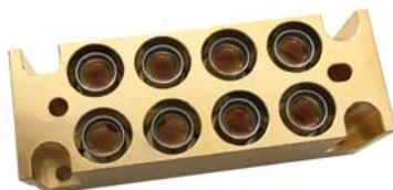
Рис. 1. Сборка лазерных диодов Nichia NUBM08
