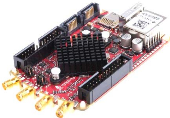
Рис. 1. Программно-аппаратная платформа Red Pitaya
