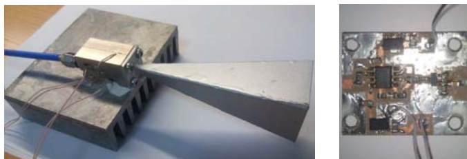
Рис. 2. Рупорная антенна и печатный узел квадратичного детектора
