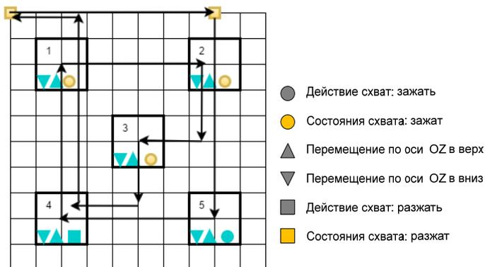
Рис. 1. Двумерная проекция траектории
