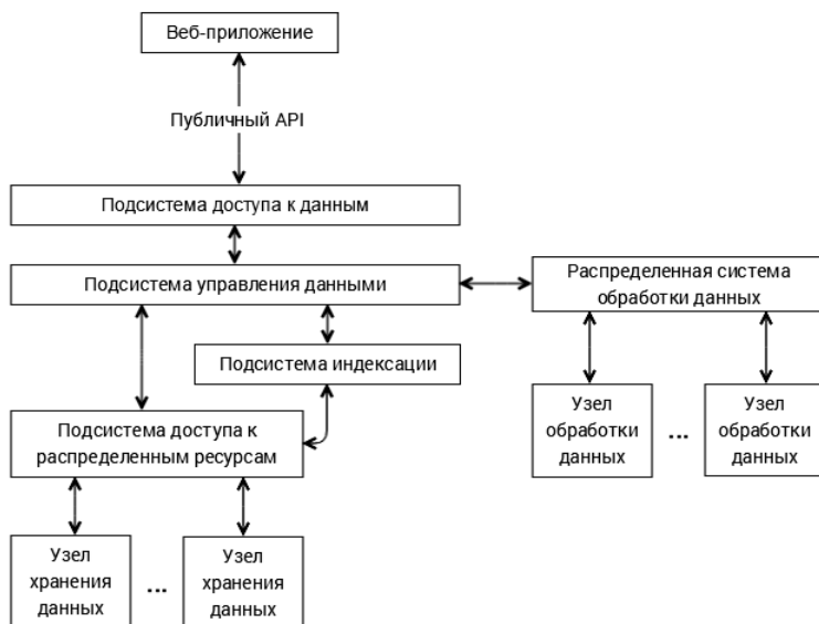
Рис. 1. Обобщенная архитектура распределенной системы хранения, поиска и обработки экспериментальных данных
