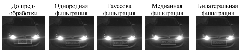
Рис. 4. Результат детектирования номерной пластины при плохом освещении
