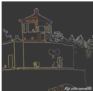
Рис. 1. Обработка изображения алгоритмом Canny
