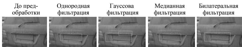
Рис. 3. Результат детектирования загрязненной номерной пластины
