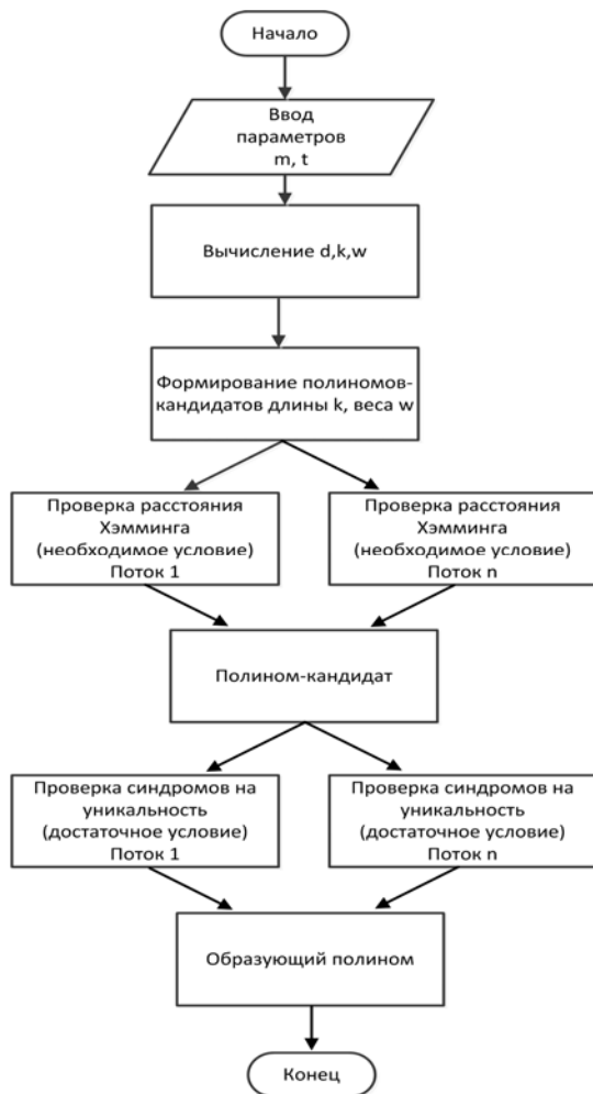
Рис. 1. Схема алгоритма поиска образующего полинома с применением технологии OpenMP
