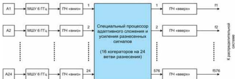
Рис. 2. Структурная схема приемного комплекса C -диапазона
