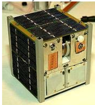
Рис. 2. Норвежский пикоспутник NCUBE2, созданный по стандарту CubeSat
