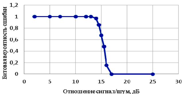
Рис. 3. Зависимость BER от SNR для стандарта ZigBee
