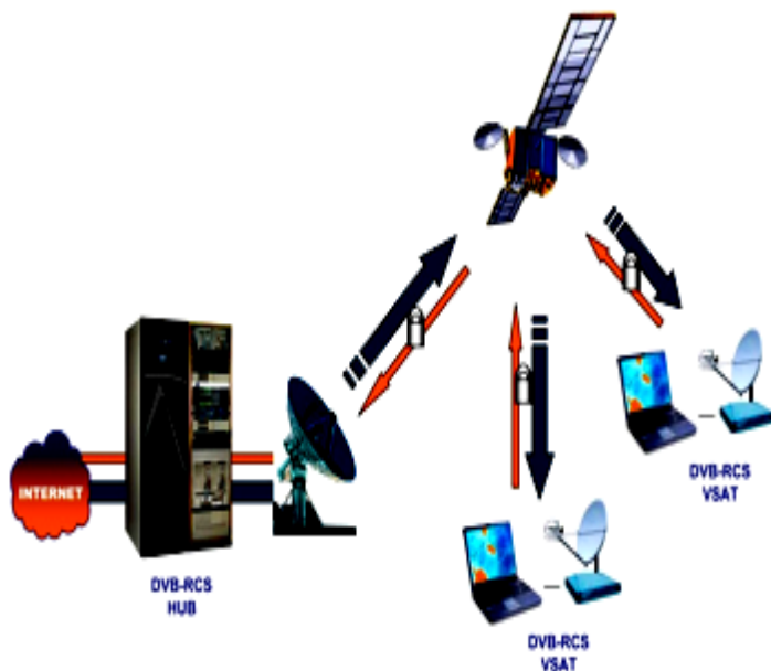
Рис. 1. Архитектура системы DVB-RCS
