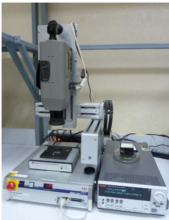
Рис. 1. Измерительный стенд для анализа вольтамперных и вольт-яркостных характеристик ОСИД-матриц
