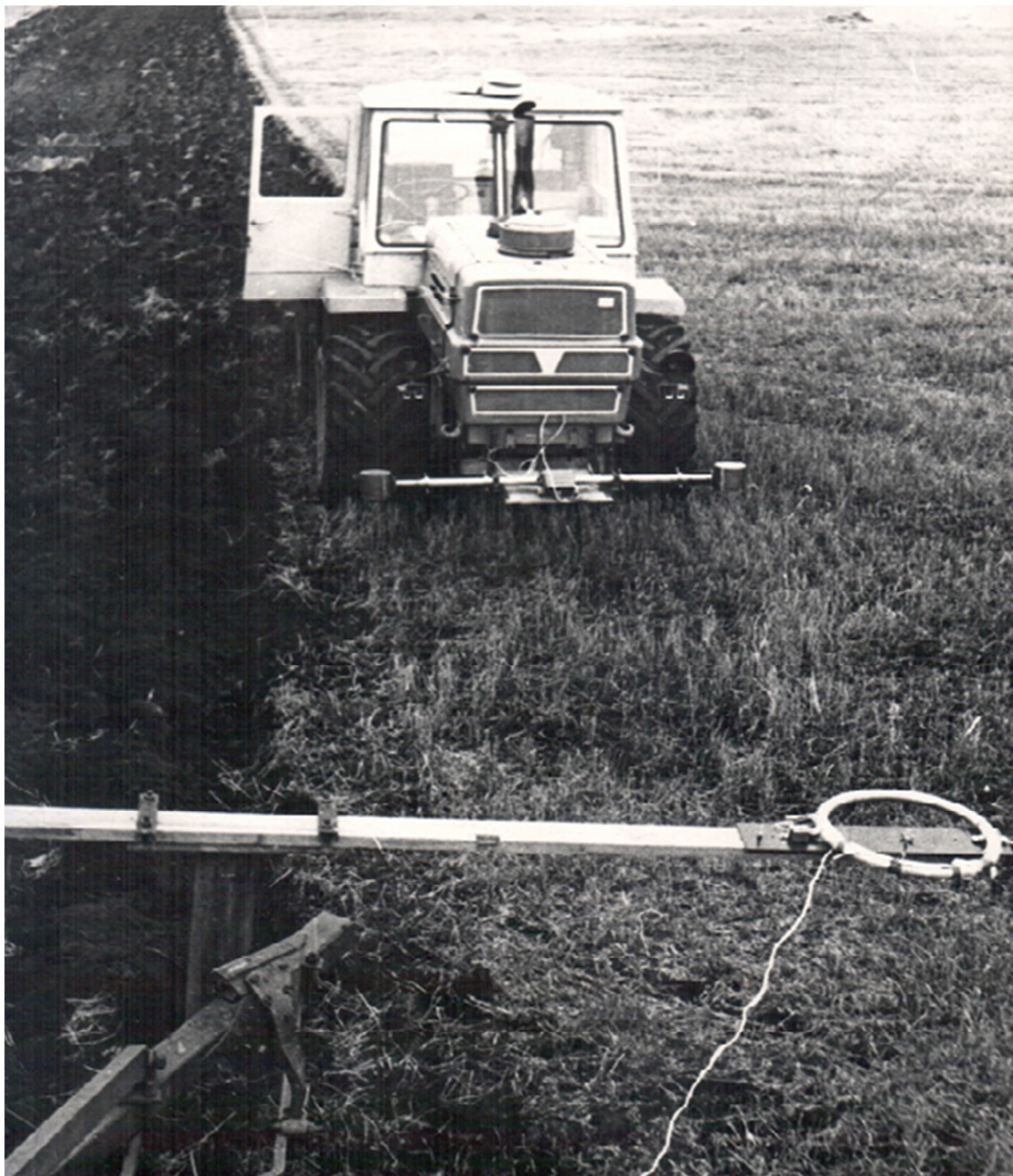
Рисунок 1.6. Групповая работа двух пахотных агрегатов с трактором-дублером на базе серийного трактора Т-150К
