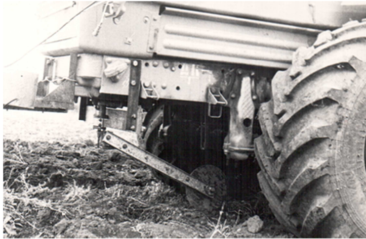
Рисунок 1.3. Курсомер для измерение угла бокового скольжения трактора
