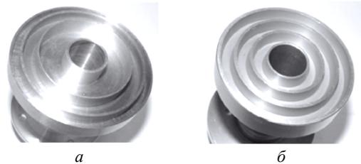
Рис. 6. Фотография прямоугольных фланцев волноводной антенны – а; трапециевидные фланцы – б
