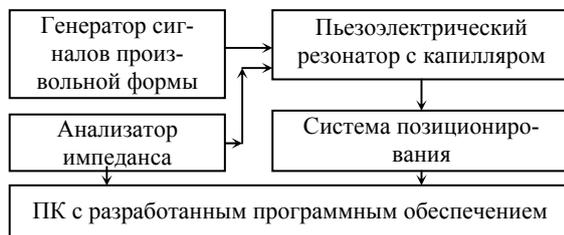
Рис. 2. Структурная схема экспериментальной установки
