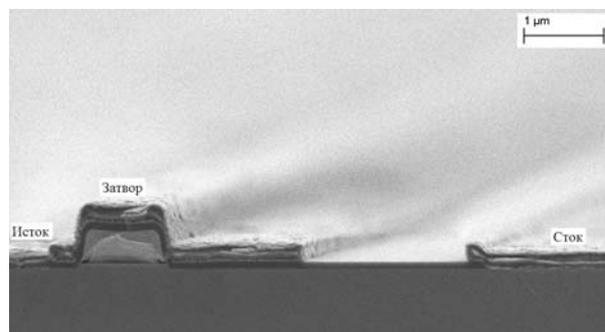
Рис. 2. Микроскопическое изображение поперечного сечения мощного GaN-транзистора с подзатворной областью на основе  $p$ -GaN
