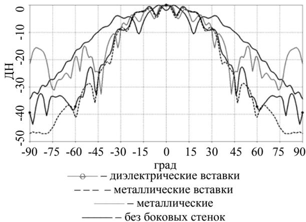
Рис. 11. ДН антенны в плоскости  $E$  на 18 ГГц при различных конструкциях боковых стенок
