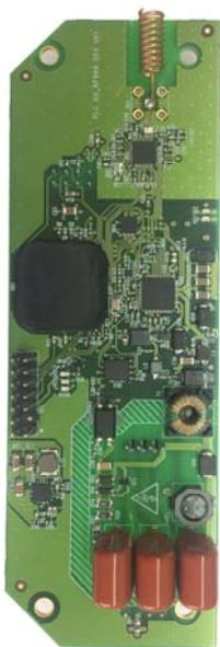
Рис. 3. Гетерогенный модем для устройства сбора и передачи данных АСКУЭ
