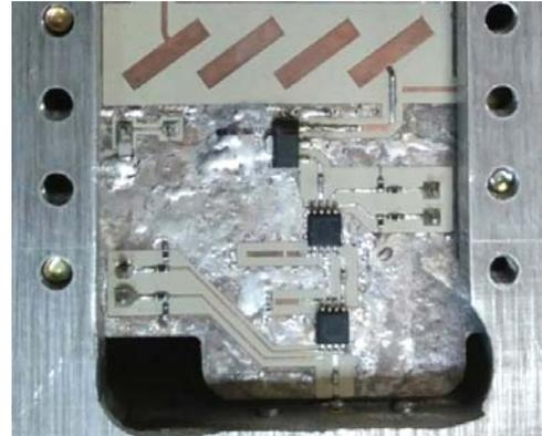
Рис. 2. Фото разработанного макета входной части нулевого радиометра
