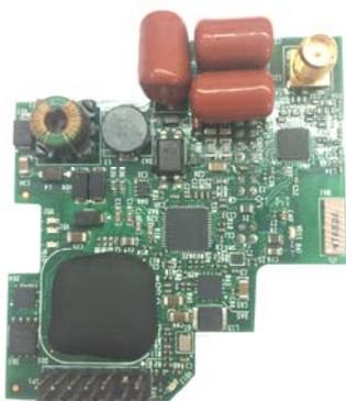
Рис. 2. Гетерогенный модем для электросчетчика
