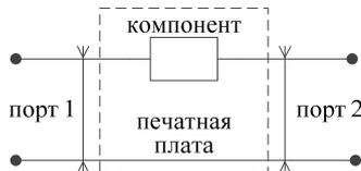
Рис. 3. Схема подключения к прибору платы (как четырёхполюсника)
