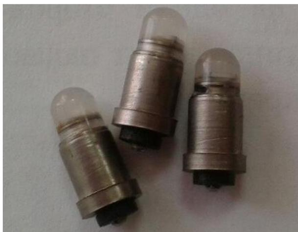
Рисунок 1 – Полупроводниковые миниатюрные лампы МП 30-0,02
