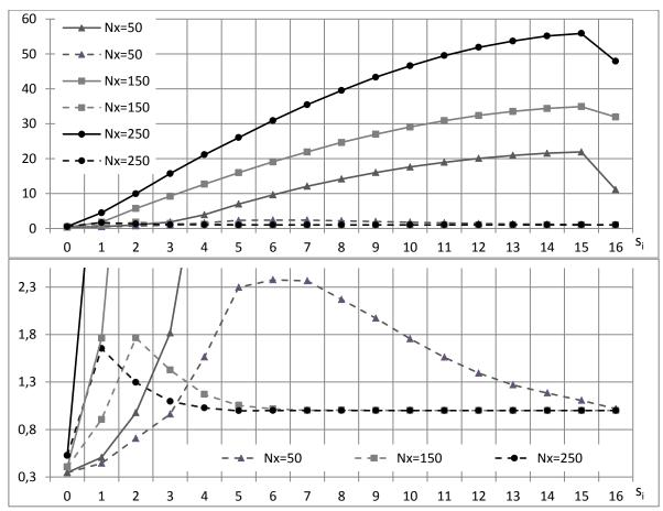
Зависимости относительной величины СКО при вычислении значений поля для традиционного (сплошная линия) и предлагаемого (пунктирная линия) методов для гармоник с разными номерами  $s_i$  усеченной плоской волны при различном количестве шагов по дальности Nx, и при  $\beta_{max}$ =0.05 рад.
