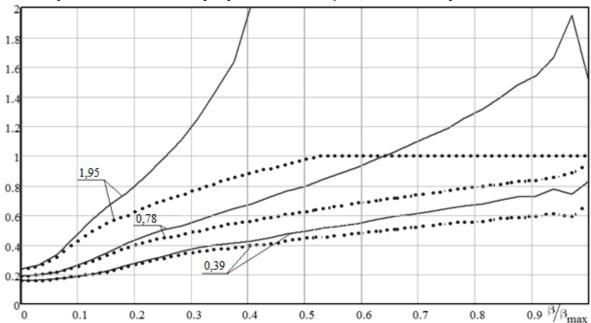
Зависимости СКО при вычислении значений поля для традиционного (сплошная линия) и предлагаемого (пунктирная линия) методов от угла падения усеченной плоской волны при различных отношениях  $x/x_{max}$ =0.39; 0.78; 1.95
