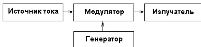
Рисунок 1 – Структурная схема установки
