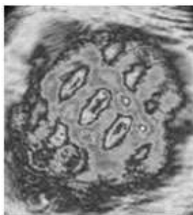
Рисунок 4. - Световое поле двумерного бесселеподобного пучка на выходной плоскости пластины \text{LiNbO}_3:\text{Cu} , полученное при \lambda=532 нм (щели перпендикулярно наложенных транспарантов расположены под углом 45^\circ к оптической оси, ширина щелей в экранах 300 мкм и 500 мкм).
