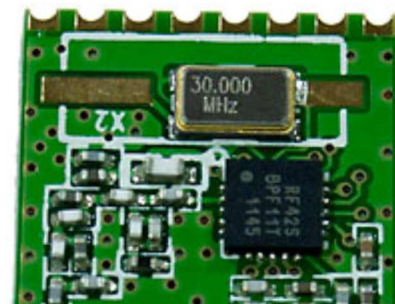
Рисунок 1.2 – Современный радиомодуль передатчик 868МГц (4x4)
