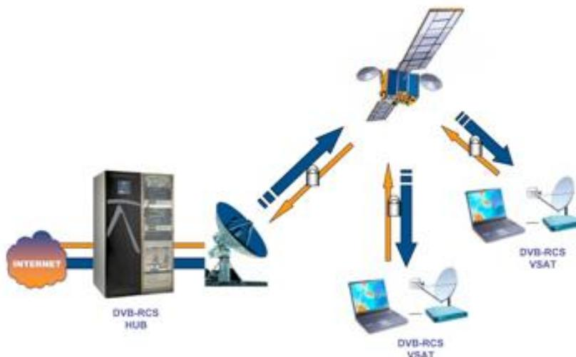
Рисунок 1 - Архитектура системы DVB-RCS
