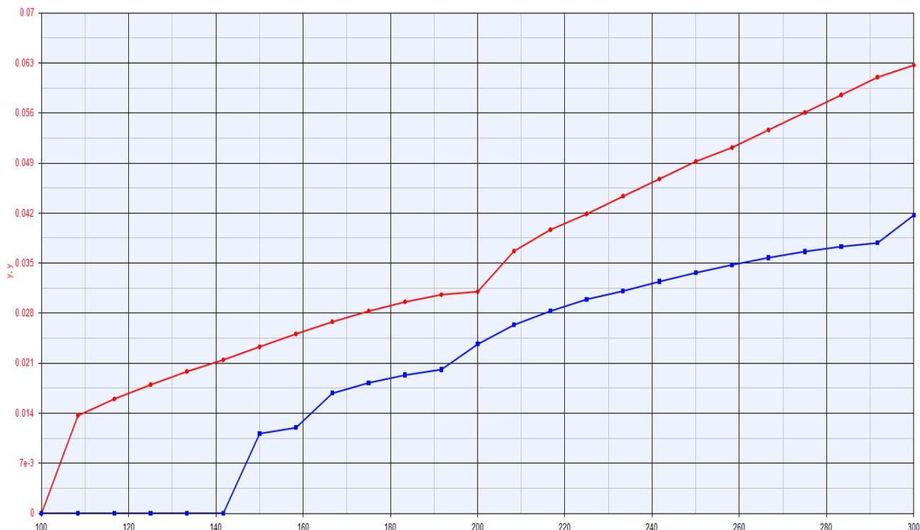
Рисунок 4 – Зависимость BER от коэффициента усиления. линейный усилитель (синий), нелинейный усилитель (красный)
