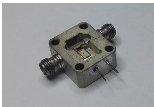
Рис. 2.2. Изображение модуля со смонтированной для проведения ускоренных испытаний GaAs СВЧ МИС МШУ
