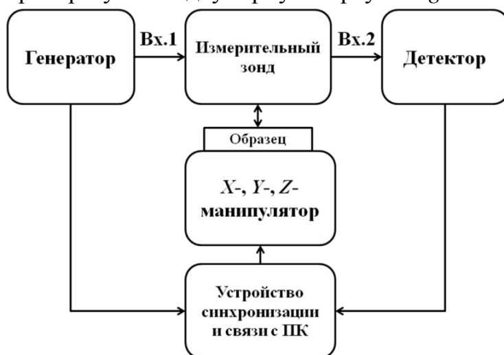
Рисунок 16. Структурная схема ближнеполевого измерителя параметров диэлектриков.
