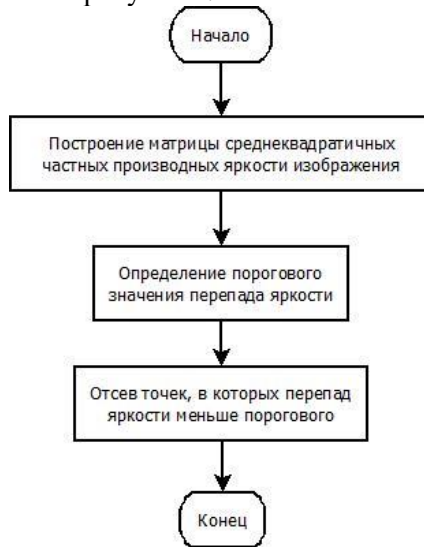
Рисунок 2 – Блок-схема основного алгоритма предварительного выделения потенциальных особенностей изображения
