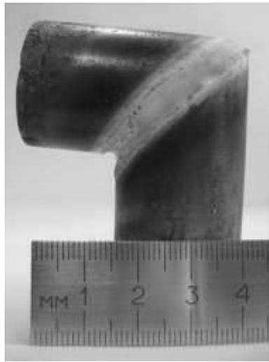
Рисунок 5.13 – Керамические трубки, сваренные под углом 90 градусов
