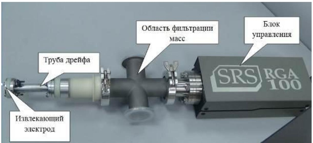
Рисунок 3.12 – Внешний вид модифицированного квадрупольного масс-анализатора
