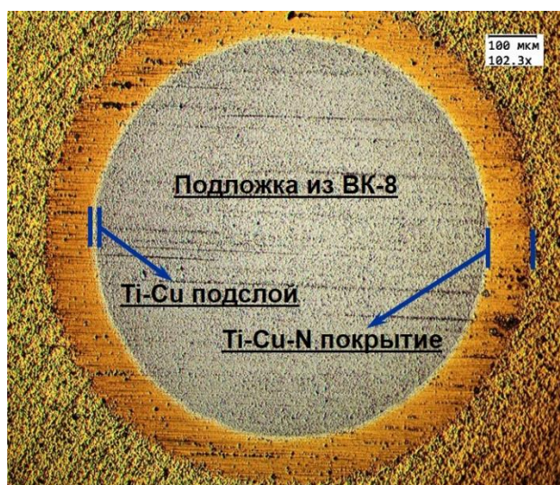
Рисунок 4.7 – Изображение отпечатка, оставленного после вращения стальным шариком с алмазной суспензией при определении толщины покрытия методом сферического шлифа
