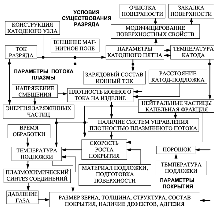
Рисунок 1.18 – Схема взаимосвязи параметров, определяющих процессы существования вакуумно-дугового разряда на интегрально-холодном катоде [81]
