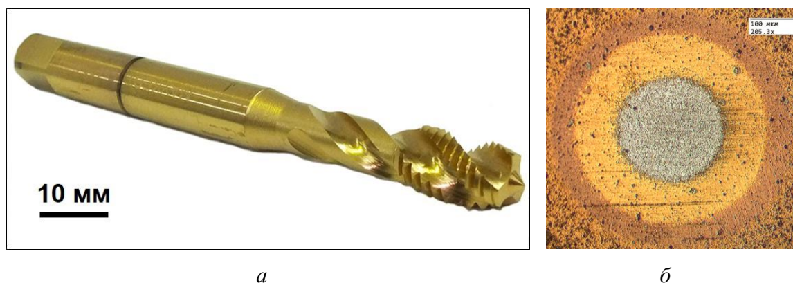
Рисунок 4.28 – Изображение метчика из быстрорежущей стали с двухслойным TiN/Ti–Cu–N покрытием, осажденным вакуумно-дуговым методом с плазменным ассистированием (а), отпечаток, оставляемый стальным шариком в системе стальная подложка/TiN/Ti–Cu–N покрытие в методе сферических шлифов (б)
