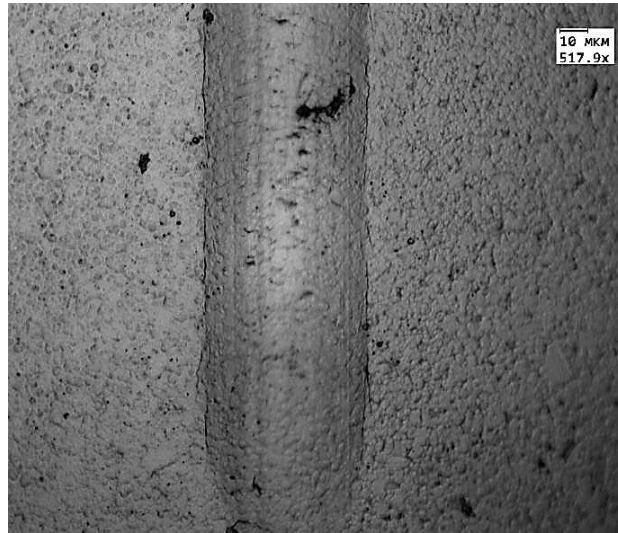
Рисунок 3.32 – Характерное изображение трека, оставленного индентером в скретч-тесте при нагрузке \approx 30 Н. Оптическая микроскопия
