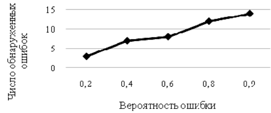
Рис. 4. Зависимость числа обнаруженных ошибок от вероятности ошибки для кода БЧХ (15, 11)
