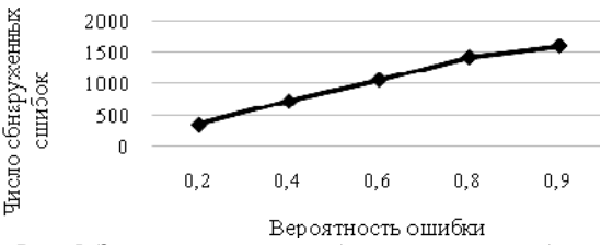
Рис. 5. Зависимость числа обнаруженных ошибок от вероятности ошибки для кода Рида–Соломона (255, 223)
