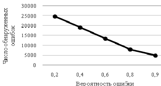
Рис. 7. Зависимость числа обнаруженных ошибок от вероятности ошибки для кода LDPC
