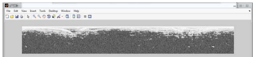
Рис. 4. Гистограммная эквализация изображения после фильтрации функцией Хаара
