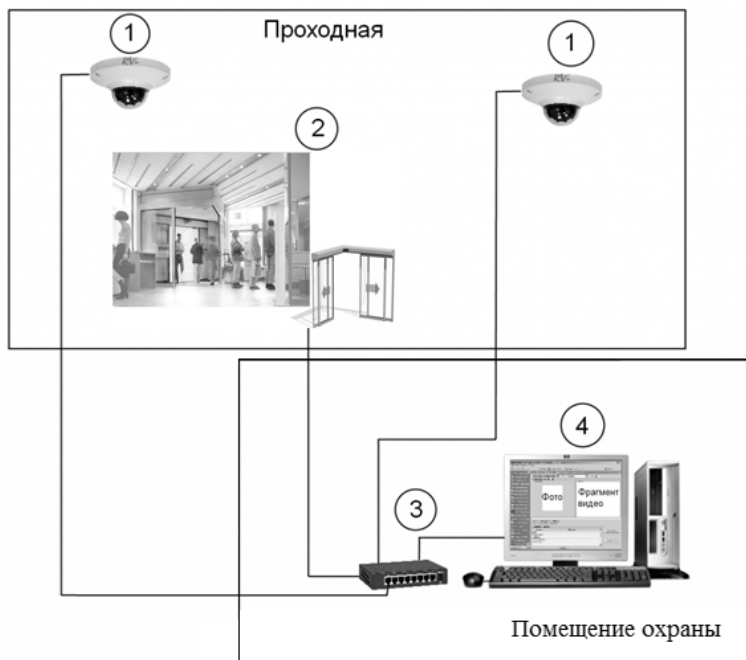
Рис. 1. Система видеонаблюдения интегрированная: 1 – чувствительная камера; 2 – автоматическая дверь встроенный сетевым контроллером; 3 – сетевой коммутатор; 4 – компьютер с программным обеспечением видеонаблюдения
