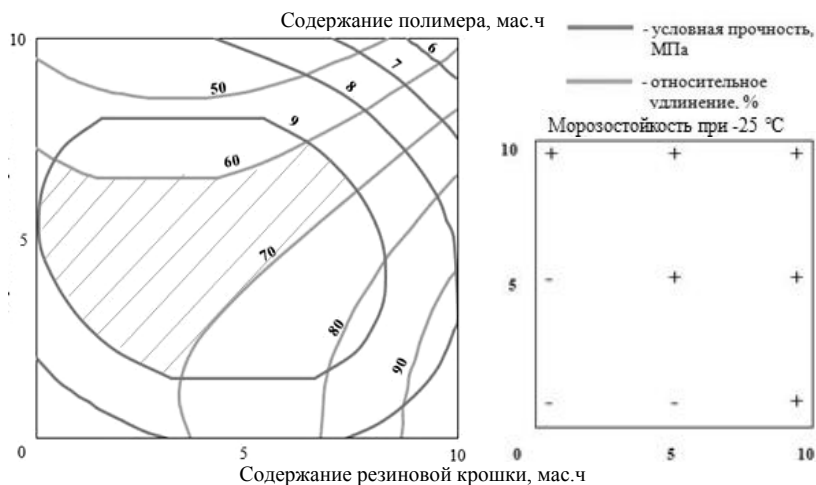
Рис. 1. Совмещенные контурные кривые для мелкодисперсной крошки
