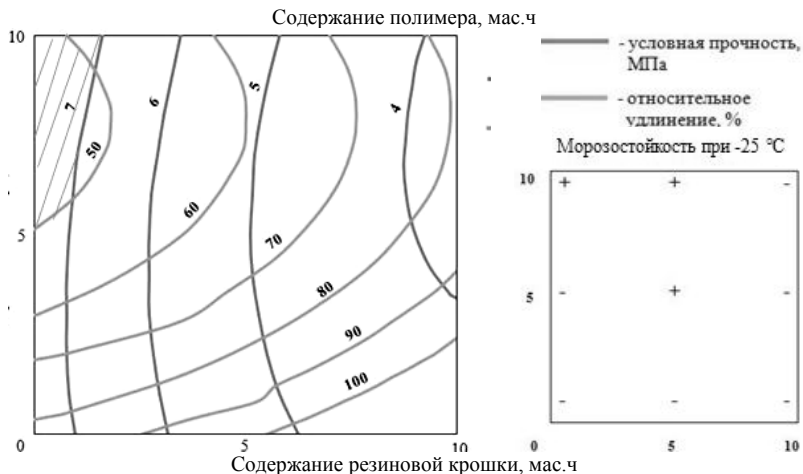
Рис. 3. Совмещенные контурные кривые для крупнодисперсной крошки
