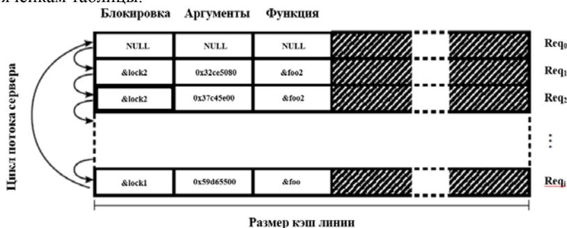
Рис. 1. Массив запросов на выполнение критических секций RCL
