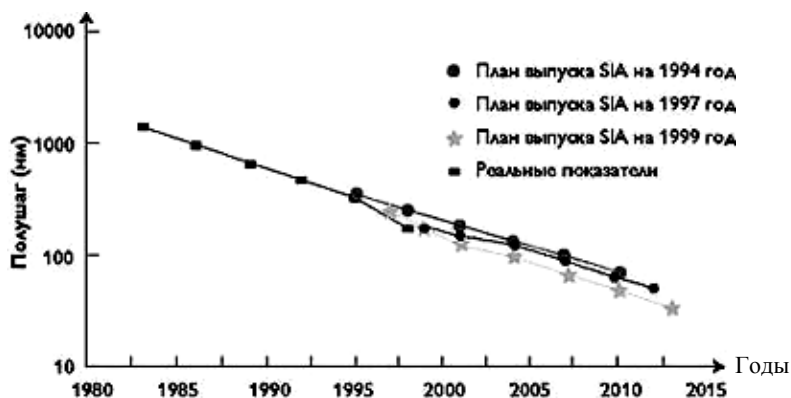
Рис. 1. Сложившиеся и новые тенденции в изменении разрешающей способности литографического процесса. Здесь полушаг – это минимальный размер литографических параметров на кристалле (SIA – Semiconductor Industry Association)
