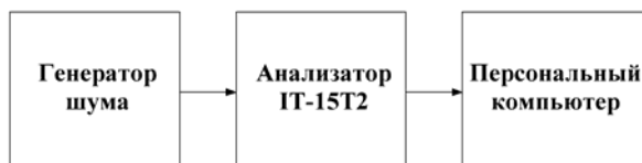
Рис. 2. Структурная схема измерения частотной характеристики генератора шума
