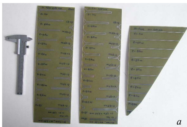
Рис. 3.4 – Фотография печатных плат (а) и осциллограммы сигналов в конце линий длиной 0,162 м (б): из одного проводника (---) и меандровой (—) при s = 0,5w
