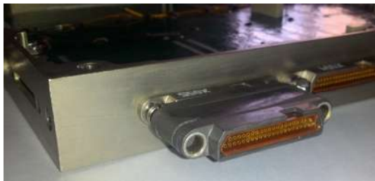
Рисунок 2.8 – Соединитель типа СНП 339 в металлическом (а) и пластмассовом (б) корпусах
