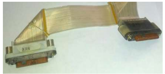
Рисунок 2.8 – Соединитель типа СНП 339 в металлическом (а) и пластмассовом (б) корпусах
