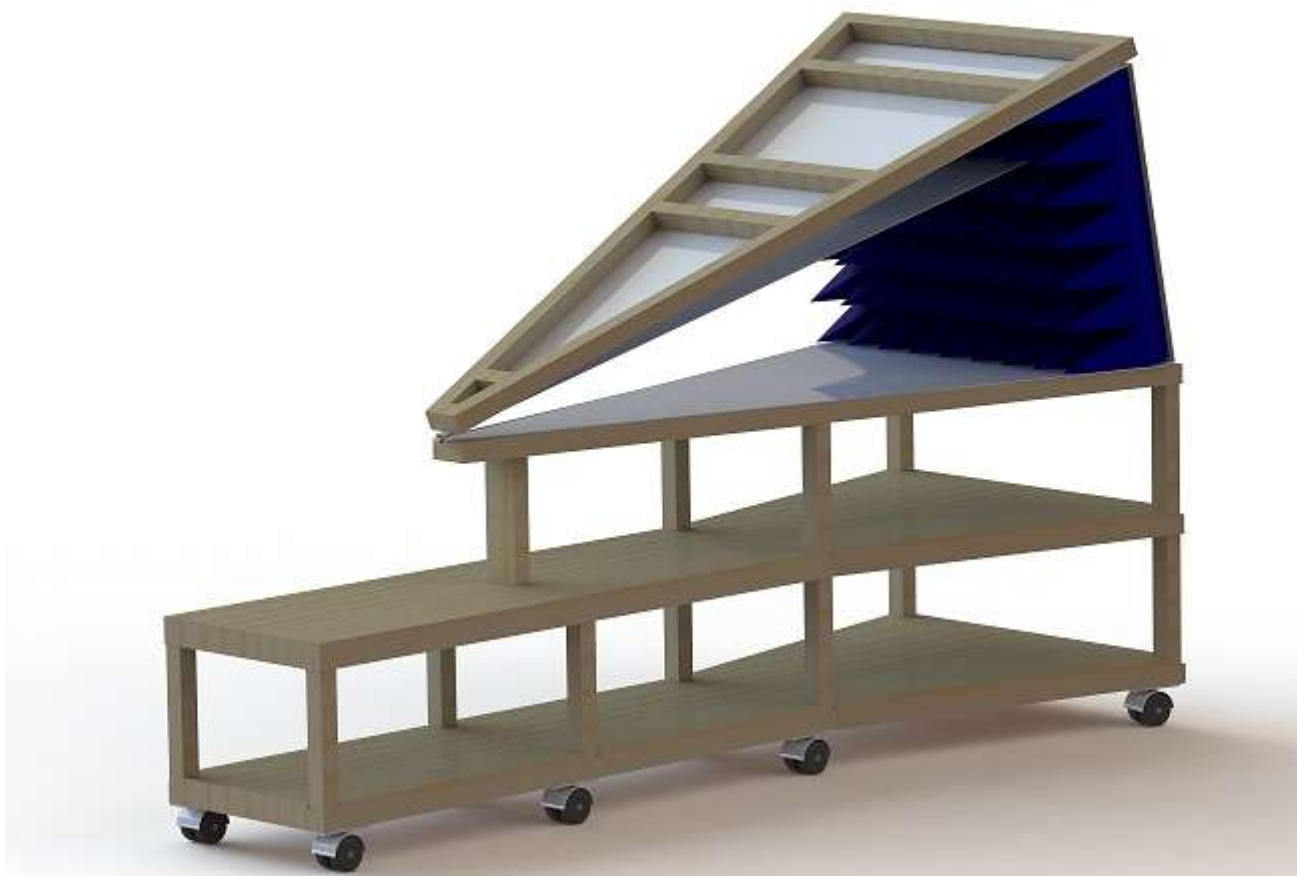
Рисунок 3.61 – Модель лабораторного макета открытой камеры GTEM-250 на передвижной подставке для приборов
