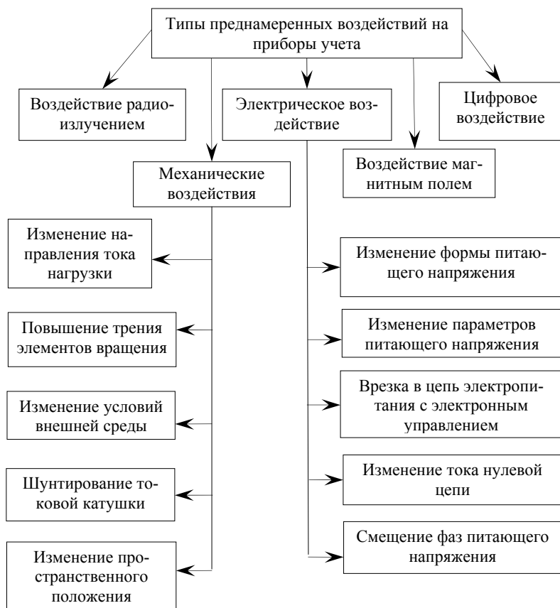
Рис. 1. Классификация способов преднамеренного воздействия на приборы учета
