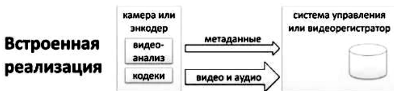
Рис. 2. Архитектура системы на базе встроенной видеоаналитики. Видеоанализ реализован «на борту» камеры, которая одновременно транслирует метаданные (видео и аудио) и метаданные (результаты видеоанализа)
