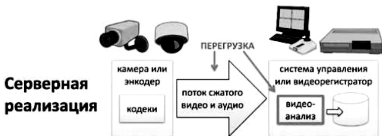
Рис. 1. Архитектура системы на базе серверной видеоаналитики. Значительный поток данных передается от камеры к серверу, где происходит декомпрессия и видеоанализ. Конечные вычислительные ресурсы сервера ограничивают масштабируемость системы
