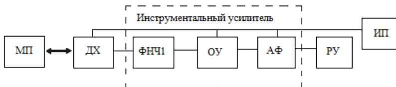
Рис. 4. Структурная схема исследования датчика Холла:
