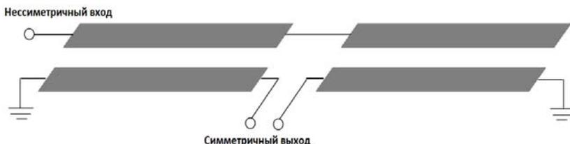
Рис. 1. Схема симметрирующего трансформатора на основе моста Маршанда
