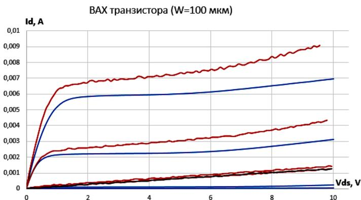
Рис. 2. Вольт-амперная характеристика тестового полевого транзистора
