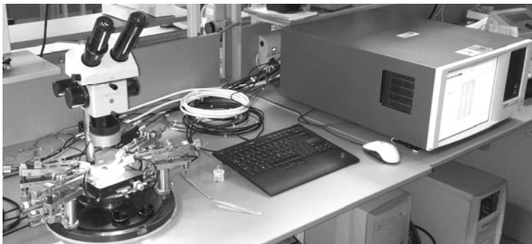
Рис. 1. Собранная зондовая станция
