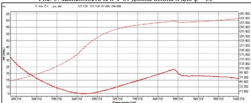
Рис. 4. Зависимость  $\Delta$  и  $\Psi$  от длины волны  $\lambda$  для  $\varphi = 70^\circ$
