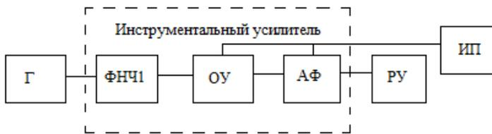
Рис. 2. Структурная схема для исследования инструментального усилителя
