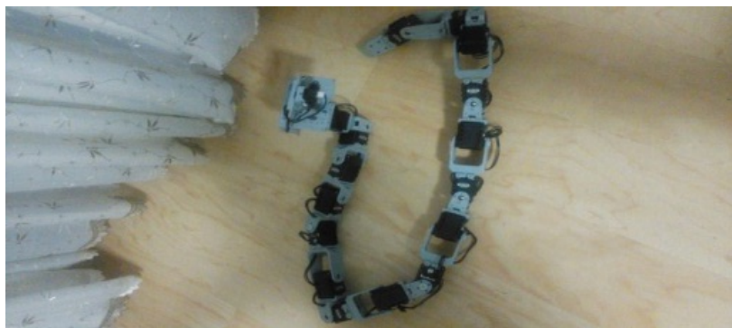
Рис. 1. Модель созданного прототипа bioloid snake
