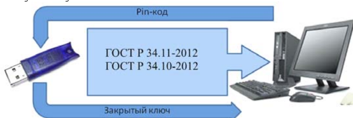
Рис. 1. Обмен информацией между ПК и токеном с извлекаемым закрытым ключом
