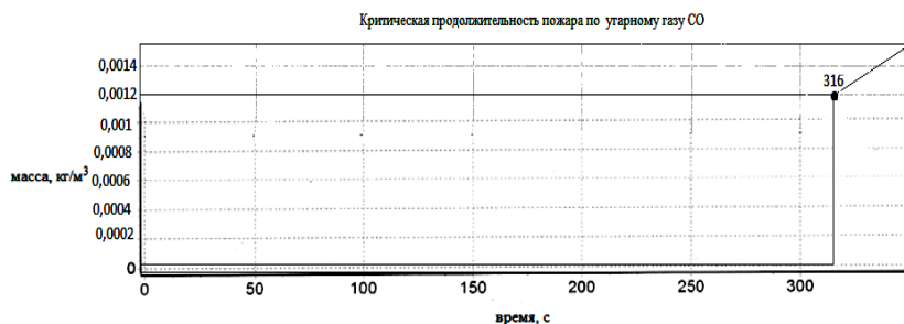
Рис. 2. Результаты расчета в виде критической продолжительности пожара по угарному газу (CO)
