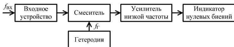
Рис. 1. Структурная схема гетеродинного метода
