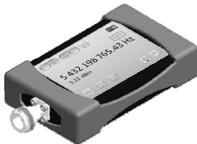
Рис. 2. Модель предлагаемого частотомера
