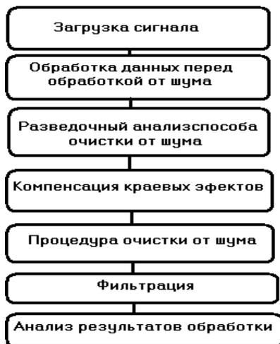
Рис. 5. Структурная схема разрабатываемого комплекса
