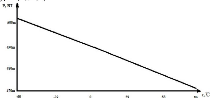
Рис. 2. Зависимость рассеиваемой мощности на транзисторе VT2 от изменения температуры
