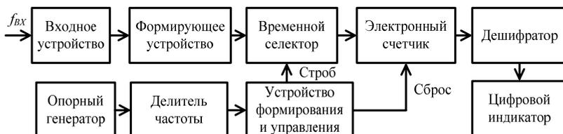
Рис. 2. Структурная схема метода дискретного счета
