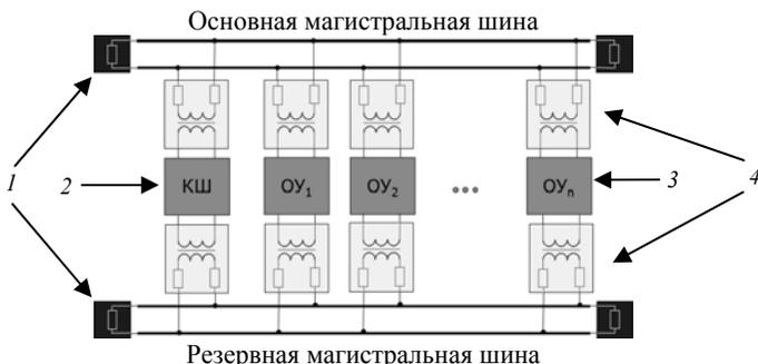
Рис. 1. Структурная схема технических средств интерфейса:
