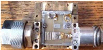
Рис. 3. Фотография СВЧ-генератора
