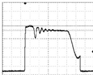
В результате проделанной работы были получены данные о влиянии времени восстановления диода на эффективность демпфирования в пассивном резистивно-конденсаторно-диодном демпфере, был сделан вывод о том, что диоды с высоким значением времени восстановления следует применять в маломощных импульсных источниках питания, с малым током в первичной обмотке.
