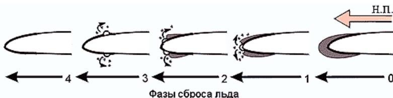
Рис. 2. Характерные формы льдообразований
