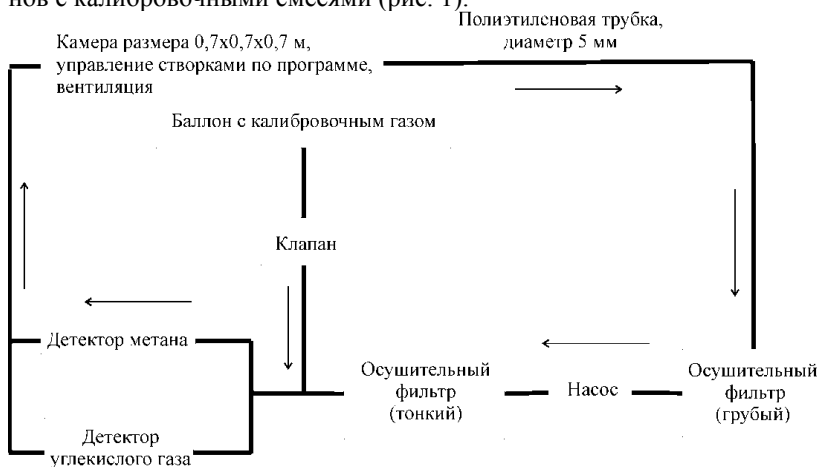
Рис. 1. Схема автоматической системы регистрации потоков метана и углекислого газа из почвы
