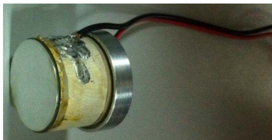
Рис. 2. Фотография пьезокерамического элемента с зеркалом
