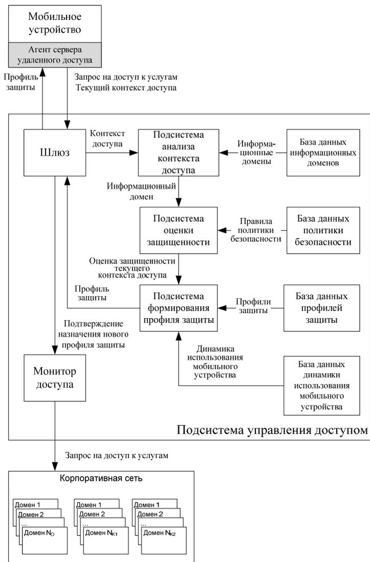
Рис. 1. Схема управления профилем защиты мобильного устройства при реализации правил политики безопасности корпоративной сети
