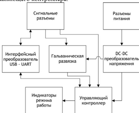
Рис. 2. Структурная схема устройства синхронизации
