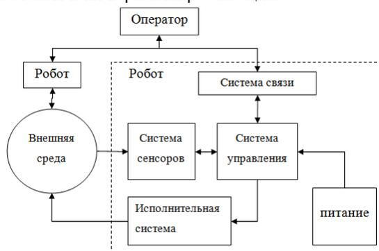
Рис. 2. Схема взаимодействия систем робота
