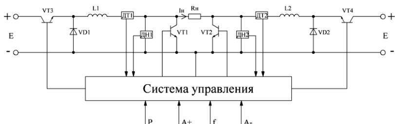
Рис. 1. Функциональная схема источника асимметричного тока или напряжения на основе непосредственных преобразователей
