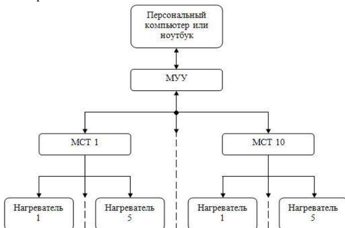
Рис. 1. Общая структурная схема модулей разрабатываемого устройства и их взаимосвязь
