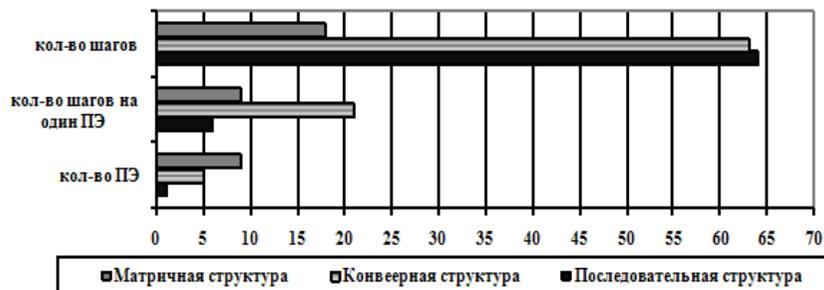
Рис. 1. Сравнительный анализ матричной, конвейерной и последовательной структуры на примере обработки изображения маской 3 на 3
