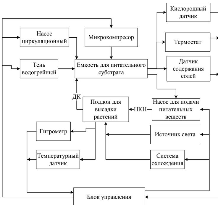
Рис. 1. Структурная блок-схема «Умная теплица на гидропонике»
