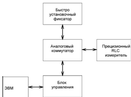
Рис. 1. Структурная схема испытательного стендамоточных изделий
