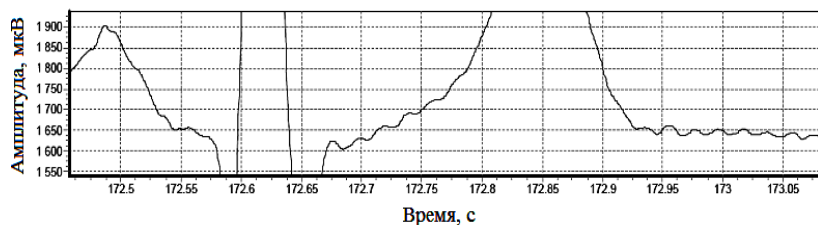
Рис. 3. Сигнал здорового человека на входе канала с ФВЧ с частотой среза 0,05 Гц
