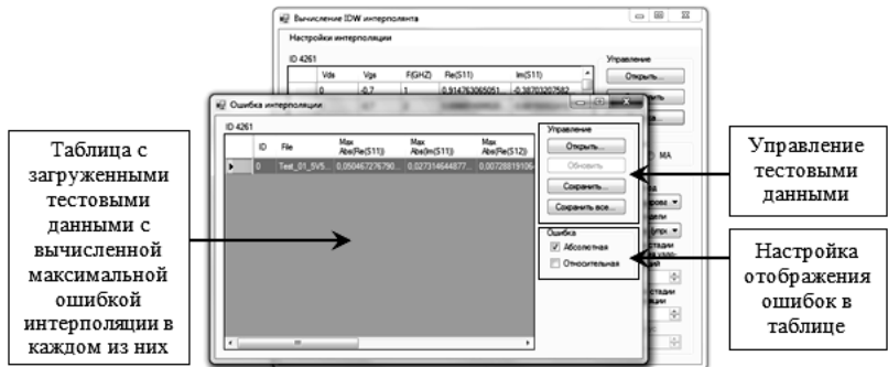
Рис. 2. Вычисление ошибок интерполяции
