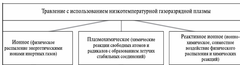
Рис. 1. Классификация процессов вакуумно-плазменного травления
