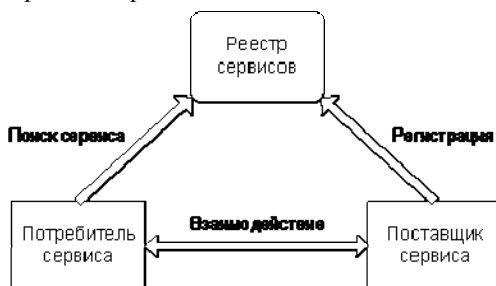
Рис. 1. Взаимодействие компонентов сервис-ориентированной архитектуры
