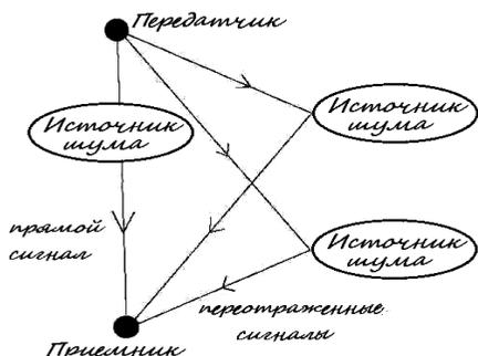
Рис. 1. Схема распространения сигнала в условиях многолучевости
