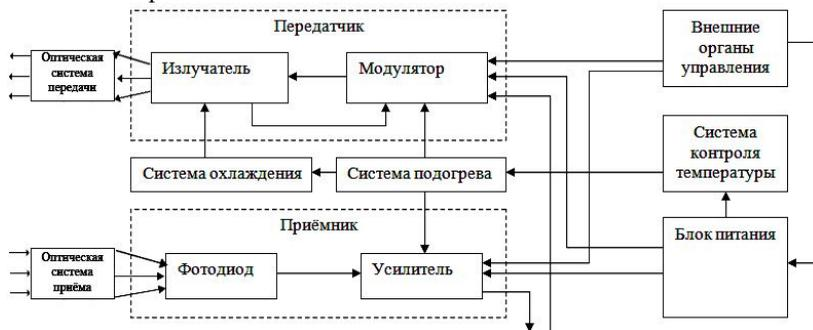
Рис. 1. Функциональная схема приёмопередающего модуля АОЛС
