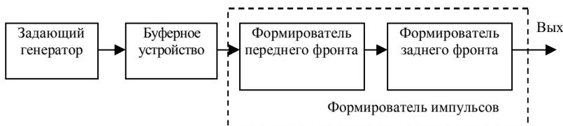
Рис. 1. Структурная схема генератора
