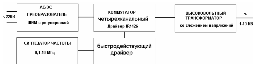
Рис. 1. Структурная схема импульсного источника питания
