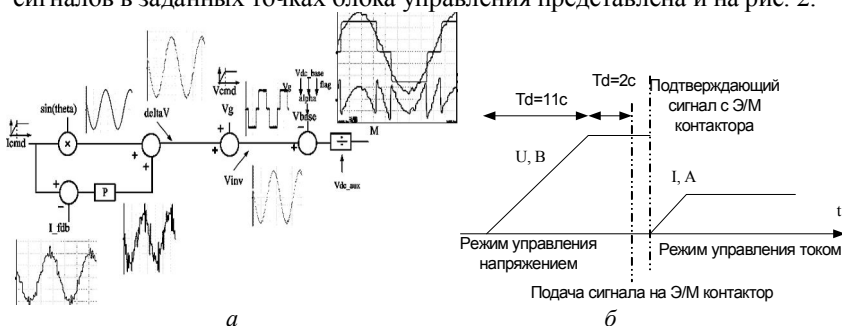
Рис. 2. Схема блока управления ШИМ – а; режимы работы – б
