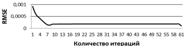
Рис. 2. Зависимость среднеквадратической ошибки от количества итераций для функции f(x_1, x_2) = x_1 \cdot \sin(x_2) , -\pi/2 < x_1, x_2 < \pi/2 , 7 термов
