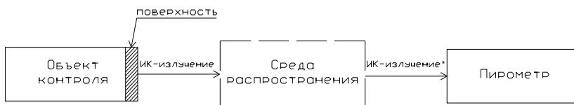
Рис. 1. Радиометрическая цепочка проведения измерения
