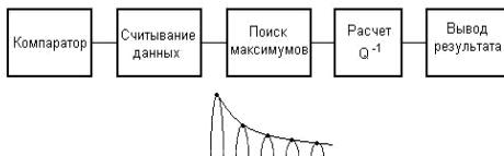
Рис. 2. Структурная схема для обработки результатов опыта
