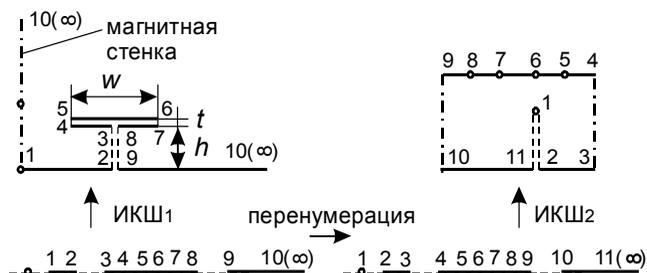
Рис. 2. Последовательность конформных отображений полуобласти поперечного сечения СМПЛ для чётной моды на каноническую область плоского конденсатора с магнитным вырезом
