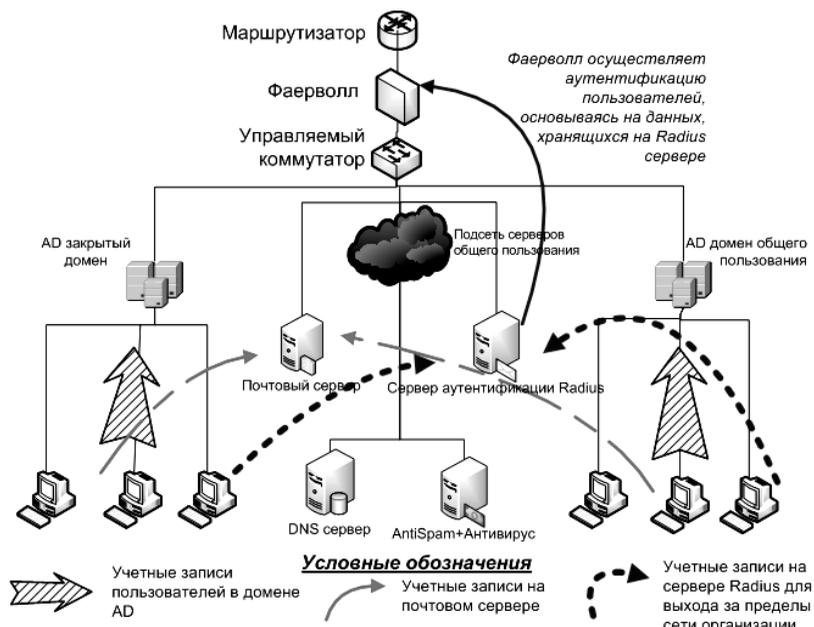
Рис. 2. Схема аутентификации в исследуемой ЛВС
