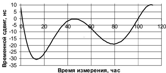
Рис. 3. Изменение временного сдвига между сигналами 1 Гц с выхода двух стандартов частоты при подстройке сигналами СРНС
