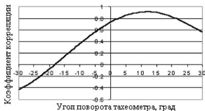
Рис. 5. Взаимная корреляционная функция азимутального разреза в точках 5 и 8
