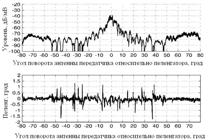
Рис. 1. Зависимости амплитуды и пеленга от угла поворота антенн передатчика, сечение 55 нс относительно начала импульса
