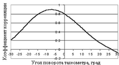
Рис. 4. Взаимная корреляционная функция азимутального разреза в точках 6 и 9
