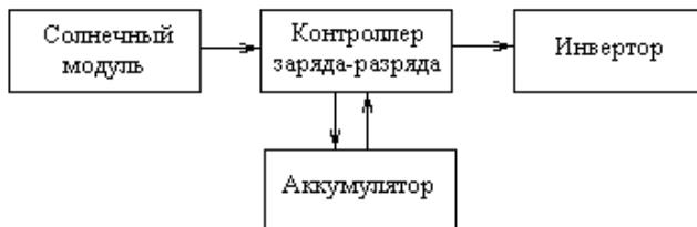
Рис. 1. Структурная схема гелиоэнергетической установки
