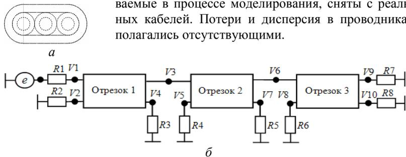
Рис. 1. Поперечное сечение кабеля (а), структура с тремя последовательно соединенными отрезками (б)
