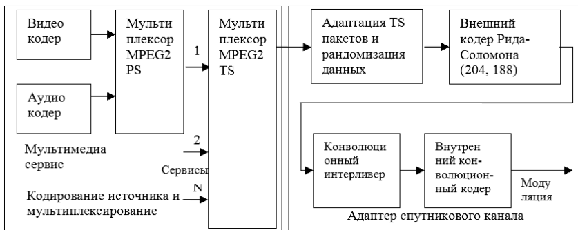
Рис. 1. Схема мультимедиа-вещания в системах DVB-S
