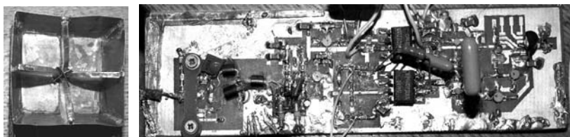
а б Рис. 2. а – Приемная антенна излучающей волны. б – Внешний вид двуканального стробоскопического приемника
