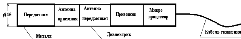
Рис. 1. Расположение основных блоков в радиолокаторе
