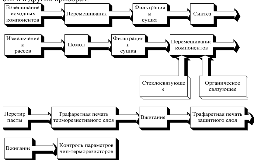
Техмаршрут изготовления материала чип-терморезистора
