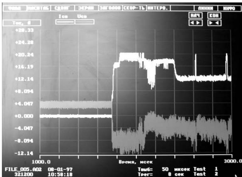
Рис. 1. Осциллограммы тока и напряжения в начальный момент сварки
