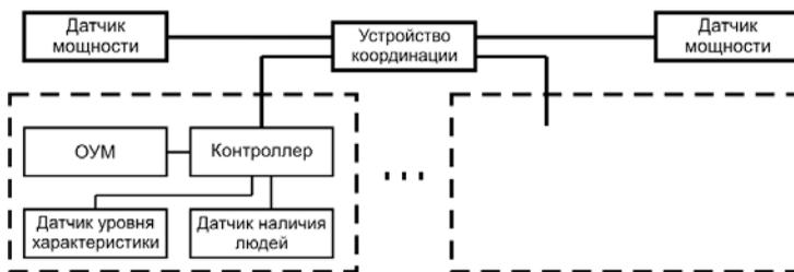
Рис. 1. Схема устройства управления микроклиматом в комплексе помещений
