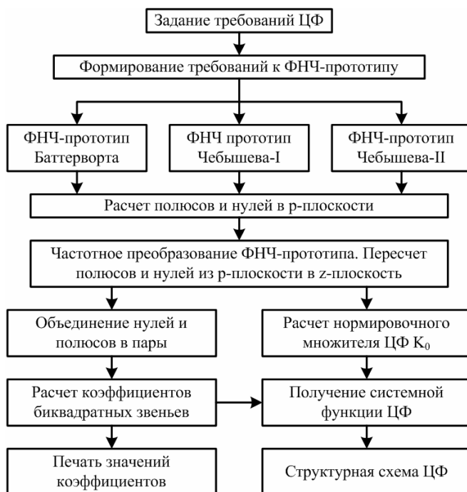
Рис. 1. Блок-схема алгоритма расчета системной функции ЦФ и его структурной схемы
