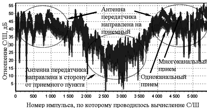
Рис. 2. Отношение сигнал/шум в зависимости от угла отворота передающей антенны
