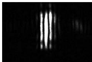
Рис. 2. Световое поле на выходе структуры при сильном насыщении видеокамеры
