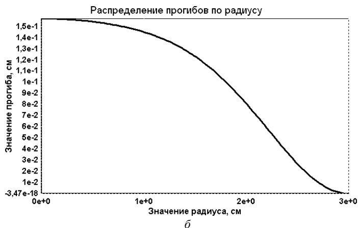
Рис. 2. Распределение прогиба по радиусу: а) – изотермическая задача при P = 0,001 МПа, T = 0 °C; б) – расчет с учетом термических напряжений P = 0,001 МПа, T = 20 °C;
